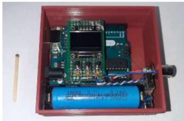
Рис. 2. Прототип цифрового осциллографа
