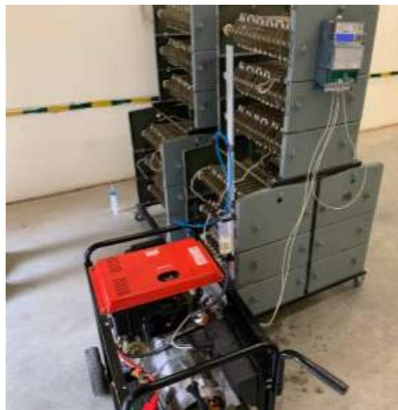
Рис. 3. Нагрузочный стенд для верификации параметров ДВС
