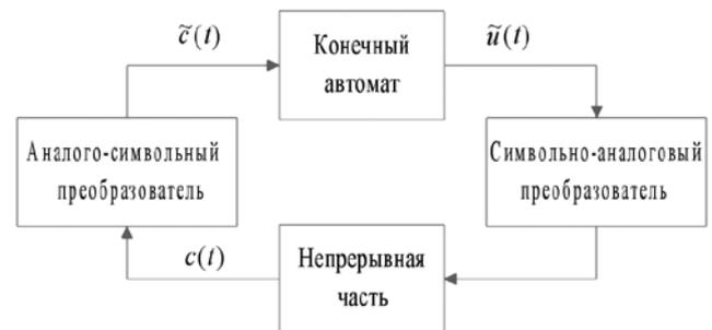
Рис. 3. Гибридная модель Нероде–Кона
