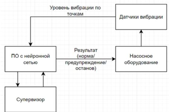
Рис. 5. Предлагаемый процесс диагностики
